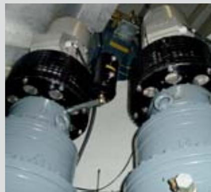
Die Turbokupplung sorgt für mehr Sicherheit und Zuverlässigkeit beim Verstellen der Gondel
