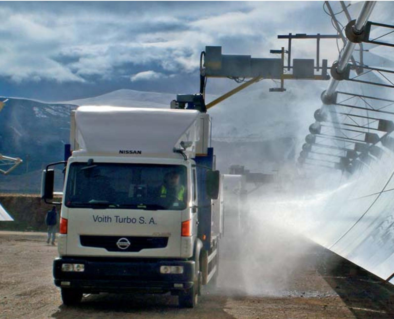
ELCOS. Fahrzeug zur Wasserhochdruck-Reinigung von Solarspiegeln
