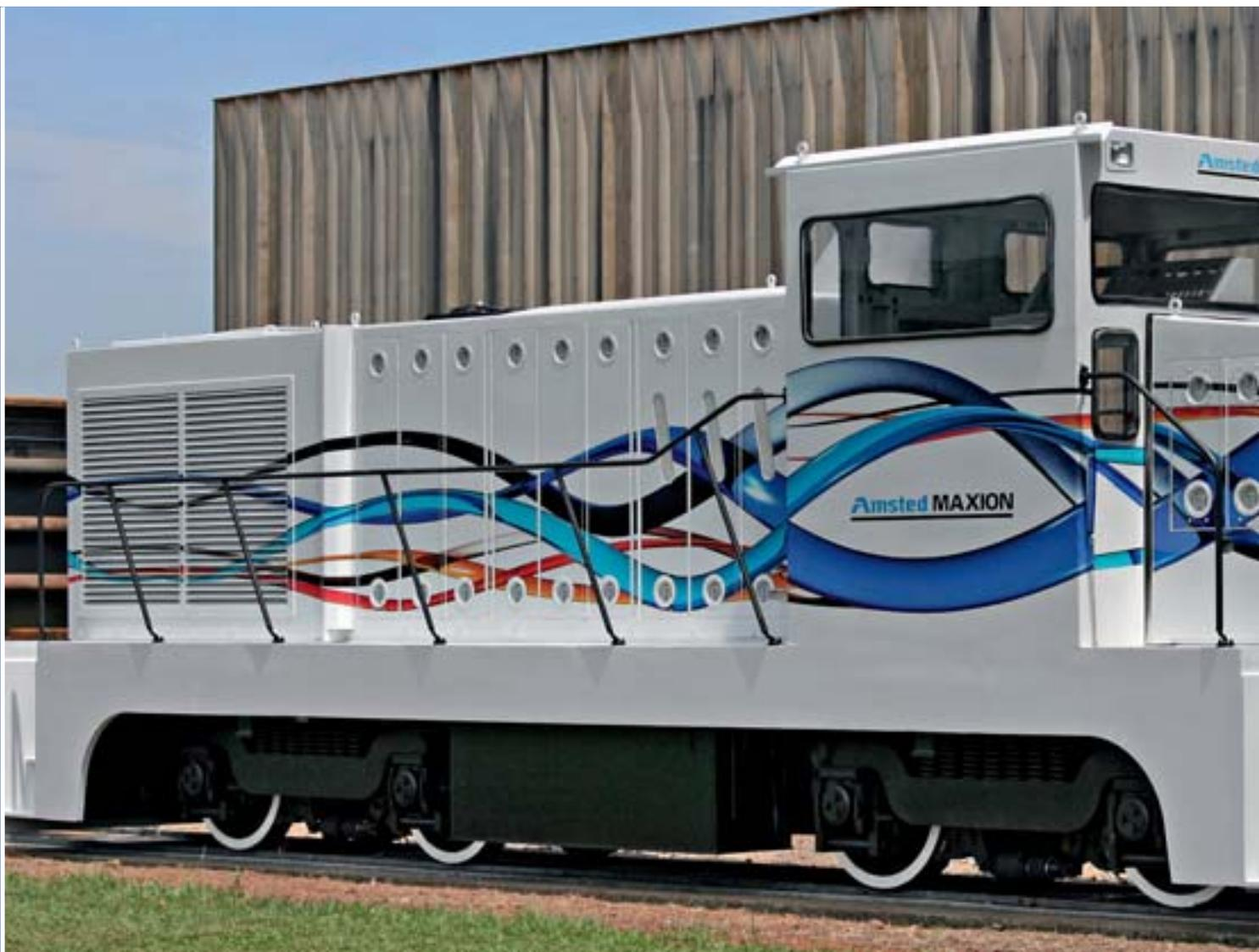
Das Voith Turbowendegetriebe L 4r4 reU2, Gelenkwellen, Radsatzgetriebe SK-553/KE-553 sowie Achswellen von Voith Turbo sind für die Leistungsübertragung des 1 000-kW-Dieselmotors auf die vier Achsen der dieselhydraulischen Rangierlokomotive DH 10 von Amsted Maxion verantwortlich. „Amsted Maxion hat auf ein vorhandenes Drehgestell einer dieselektrischen Lokomotive praktisch eine komplett
